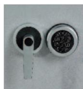
Serrure de coffre-fort classe 2 VDS, 1 000 000 de combinaisons alphanumériques, intâtable, temporisée après la 3<sup>e</sup> erreur. 1 code maître et un code utilisateur programmables. Condamnation automatique à la fermeture de l'armoire. Alimentation par pile avec système extérieur de secours.
